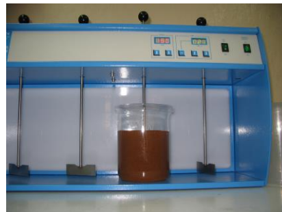
Rys.4. Schemat stanowiska laboratoryjnego do badania procesu MIEX ® DOC.
