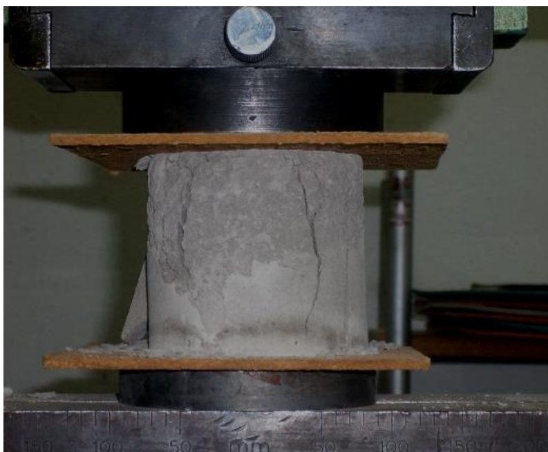
Rys. 2. Pomiar wytrzymałości mechanicznej na ściskanie.
