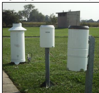
Rys. 6.6. Deszczomierze na stacji meteorologicznej IMGW w Legnicy, od lewej: pluwiografy pływakowy i korytkowy (SEBA) oraz deszczomierz Hellmanna
